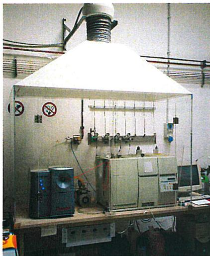
Figura 7: Apparato da laboratorio per le misure di adsorbimento di H<sub>2</sub>S
